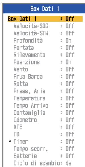
Il timer esegue il conteggio da 0H00M a 99H59M. È possibile azzerare il timer utilizzando il tasto [MARK].
