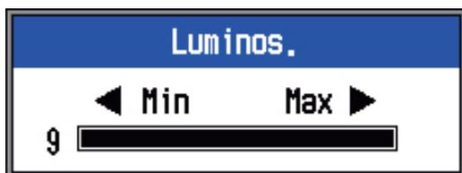
2. Premere il tasto [⏻/BRILL] per regolare la luminosità. La pressione continua del tasto consente di regolare la luminosità in modo ciclico. (0→1→...→9→8→...→0→1→...). "0" è il valore minimo e "9" il valore massimo. È possibile anche utilizzare ◀ ▶ per la regolazione.
