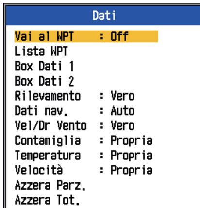
**Box Dati 1, Box Dati 2:** attivare questa funzione per visualizzare i dati nell'angolo superiore sinistro dello schermo. Se vengono attivati diversi elementi dati, questi vengono visualizzati alternativamente in base all'intervallo (predefinito: 4 s) scelto con l'opzione Ciclo di scambio. I dati diversi dalla profondità e dal timer richiedono un sensore adeguato.
