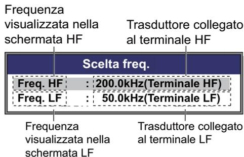
(1) Trasduttore da 200 kHz collegato al terminale HF; trasduttore da 50 kHz collegato al terminale LF
