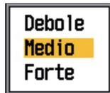
14. Utilizzare ▲ o ▼ per selezionare il livello di intensità dell'eco che attiverà l'allarme pesce.
