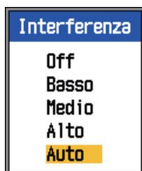
4. Utilizzare ▲ o ▼ per attivare o disattivare la funzione di eliminazione delle interferenze e premere il tasto [ENTER].
