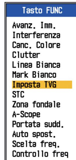
2. Utilizzare ▲ o ▼ (o ruotare il controllo [FUNCTION]) per selezionare l'elemento che si desidera programmare per il controllo [FUNCTION].
